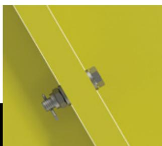
doppelt gesicherte Verschraubung
